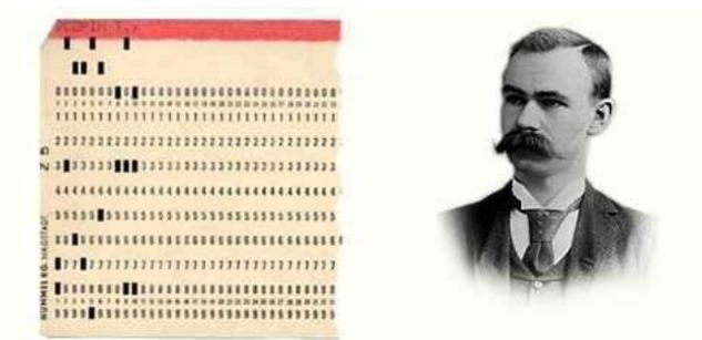
Hermann Holerith (1860–1929), Begründer der maschinellen Datenverarbeitung. IBM ließ sich 1928 das Format patentieren: 80 Spalten, 12 Zeilen und rechteckige Löcher an den Schnittpunkten.
